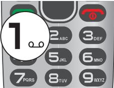
**Taste 1** erzeugt einen Punkt / bei zweifachem Drücken ein Komma usw.
